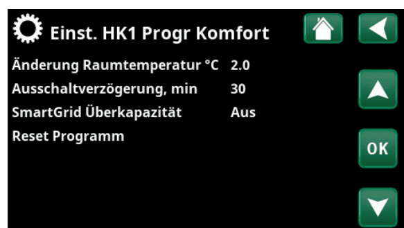
Menü „Fachmann/Definieren/Heizkreis/Heizkreis 1/Programm/ Komfort“.
