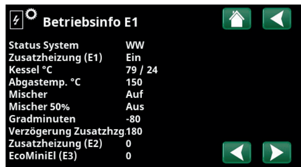
Menü „Betriebsinfo E1“ Das Beispiel enthält auch die Menüleisten für die Zusatzheizungen E2 und E3.
