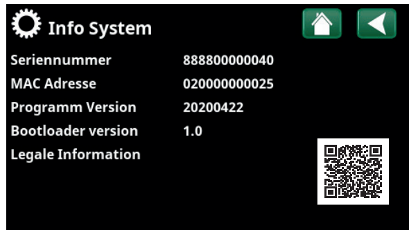
Menü: Zum Menü „Fachmann/Info System“ kommen Sie, wenn Sie die Schaltfläche „i“ unten links im Menü „Fachmann“ anklicken.
