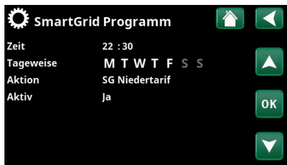
Die Funktion SmartGrid „SG Niedertarif“ ist für Wochentage zwischen 22:30 und 06:00 vorgesehen. Das Menü erscheint, wenn Sie im Menü „Fachmann/Einstellungen“ das „SmartGrid Wochenprogramm“ anwählen.
