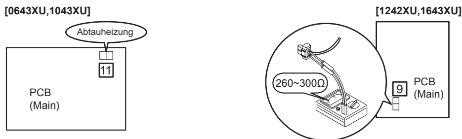
[Abb. 5] Widerstand der Abtauheizung
